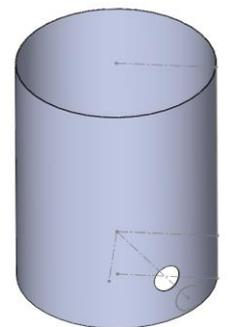
Afin de réaliser la préparation des bords à souder réaliser deux chanfreins de 2 à 45° sur l'ouverture de la virole
