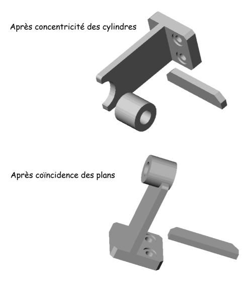
Semelle + paroi et palier cylindrique avec la nervure :
